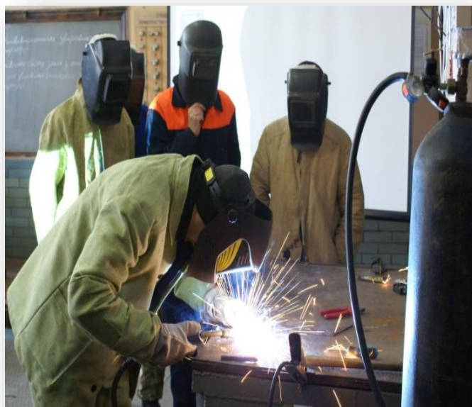
Виконання майстром виробничого навчання Воскобойніковим Г.О. кисневого різання профільного металу по прямолінійній та криволінійній розмітці.
